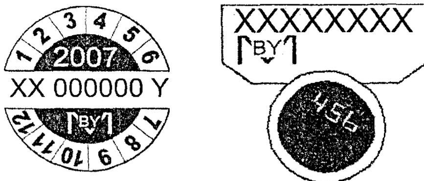
**Рисунок 3. Изображение клейма - наклейки, роторной или аналогичной пломбы для применения юридическими лицами ГМС**
